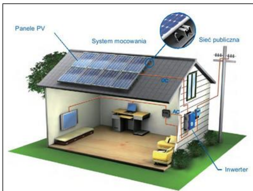
Rysunek 4. Schemat montażu i działania paneli fotowoltaicznych
